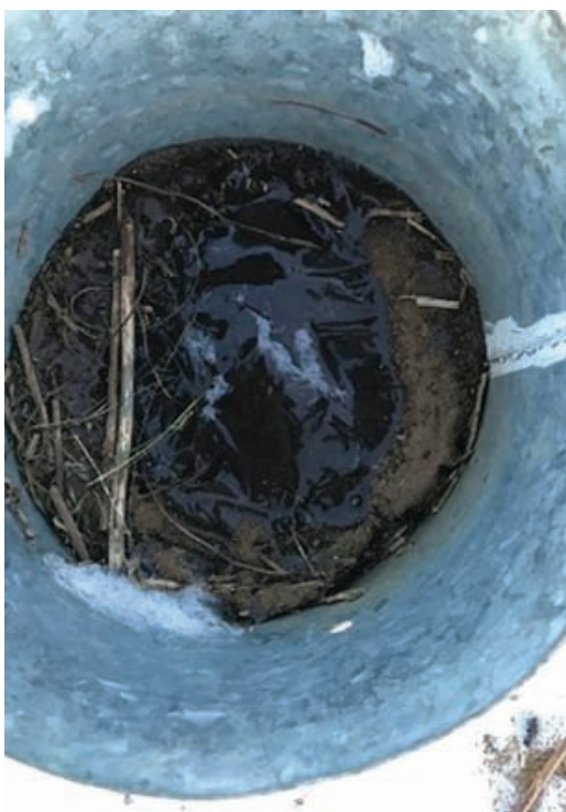
Mynd 23.5. Mynd til vinstri: Röð fyrir ísig í lúpínubreiðu að vetri í Garðabæ. Vatni er hellt ofan í rörið og mælt hve hratt það streymir niður í moldina. Hér er klaki á yfirborði en undir er ógegndræpur ís svo vatnið kemst ekki niður. Mynd: Tarek A.M. Zaqout. Mynd til hægri: Ógróinn svörður í lúpínubreiðu að vetrarlagi. Hér myndast þéttur klaki og ísnálar í yfirborði á vetrum.
